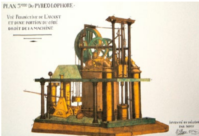
Widok aksometryczny piroloforu
