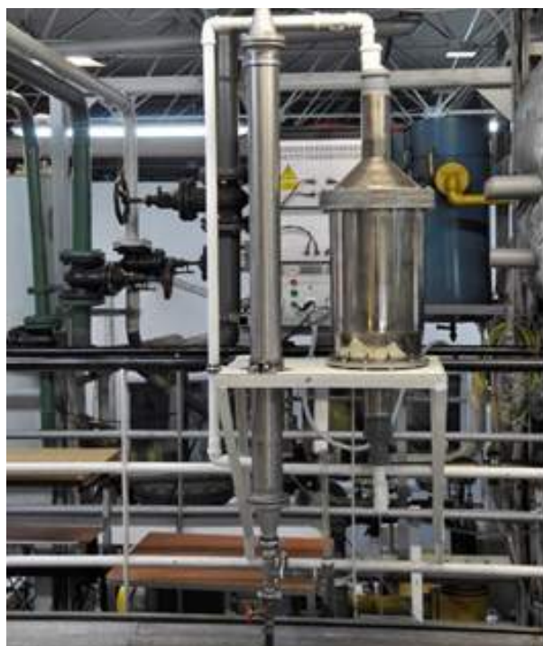
Fot. 1.3. Opracowana w trakcie realizacji projektu ENVISUM badawcza, eksperymentalna instalacja oczyszczania spalin z silnika okrętowego zainstalowanego w Laboratorium Siłowni Okrętowych Instytutu Eksploatacji Siłowni Okrętowych Akademii Morskiej w Szczecinie
