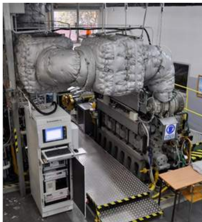
Fot. 1.3. Opracowana w trakcie realizacji projektu ENVISUM badawcza, eksperymentalna instalacja oczyszczania spalin z silnika okrętowego zainstalowanego w Laboratorium Siłowni Okrętowych Instytutu Eksploatacji Siłowni Okrętowych Akademii Morskiej w Szczecinie
