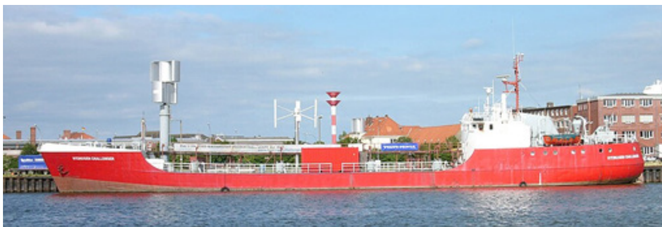
Napędzany wodorem i energią wiatru statek Hydrogen Challenger w porcie Bremerhaven w 2006 roku (Wikimedia, licencja CC BY-SA, 2.5)
