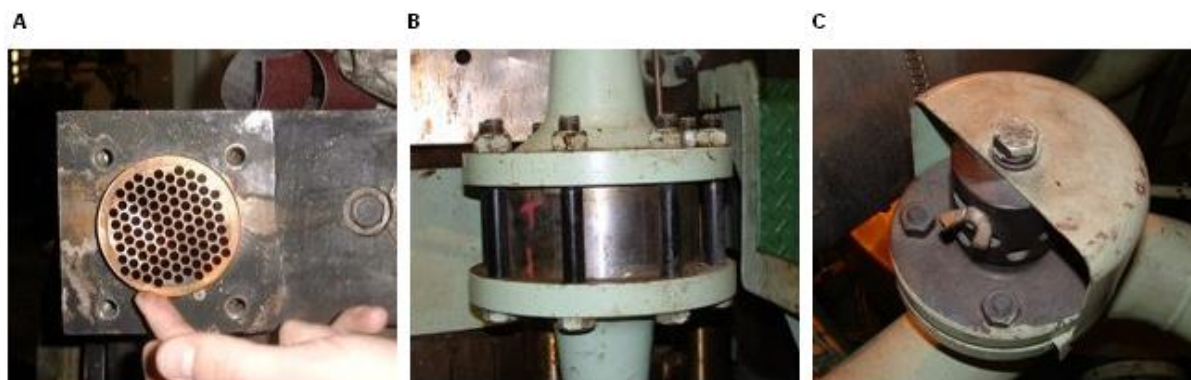
Rys. 3 Widok podstawowych elementów zabezpieczających dla kolektorów powietrza rozruchowego, A – wygaszacz płomienia stosowany w silnikach MAN B&W L58/67, B – wygaszacz płomienia stosowany w silnikach Wartsila Sulzer RTA, C – bezpiecznik membranowy firmy MAN B&W [6]
