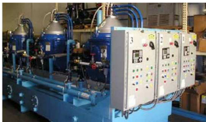
Rys. 10. System wirówek paliwa jako przykład progowej struktury niezawodnościowej
