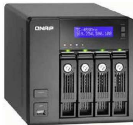
Rys. 4. Macierz dyskowa jako system o równoległej strukturze niezawodnościowej
