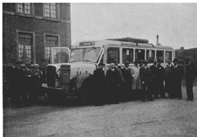
Autobus zasilany silnikiem na amoniak. Zbiorniki gazu umieszczone na froncie i na dachu pojazdu (Źródło: [3]).
